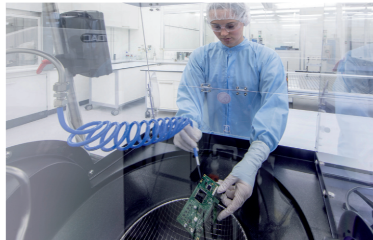
Extraktion der Partikel von einem Bauteil nach VDA Band 19.1.
