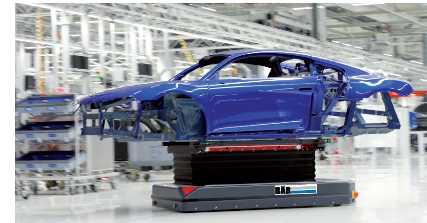
Automontage der Zukunft: Die Firma Bär Automation hat zusammen mit dem Fraunhofer IPA frei navigierende FTF für die Automobilproduktion realisiert, die die Karossen zu den Montagestationen bringen. Quelle: Bär Automation GmbH, Foto: Wolfram Scheible.
